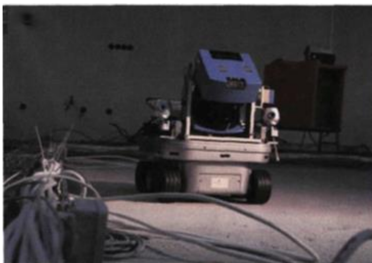
1.7 сурет - Kurt3D мобильді роботы
